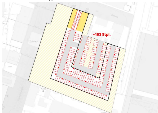
Abbildung 13: Skizzierte Kapazität der Tiefgarage bei Abweichung von der möglichen Gebäudefläche. Eigene Darstellung.
