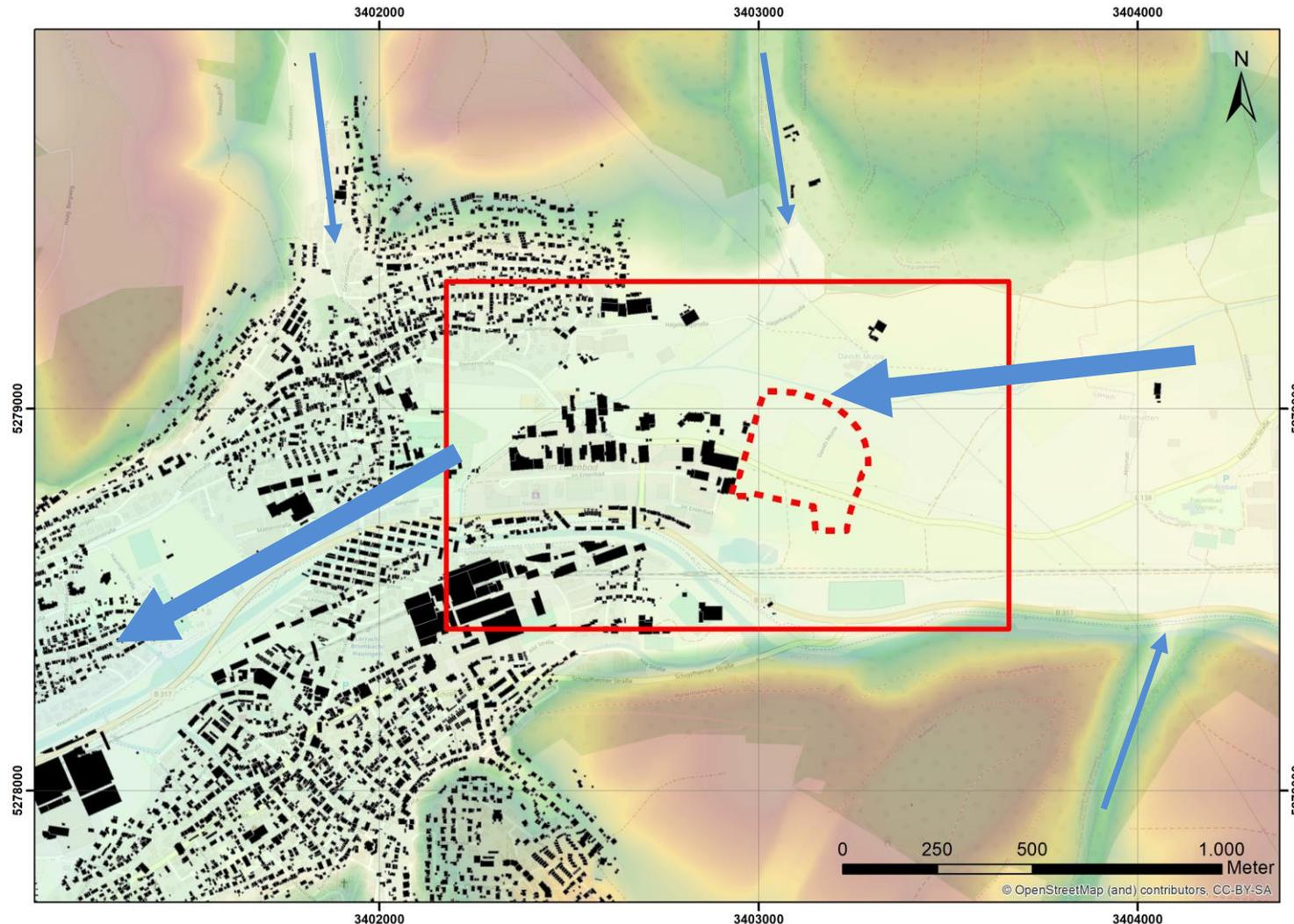
**Abbildung 2:** Topographische Verhältnisse im Bereich Lörrach-Hauingen. Die größten Höhen werden im Nordwesten (ca. 450 m ü.NN), die geringsten zentral im Wiesental (ca. 300 m ü.NN) erreicht. Roter Rahmen = MISKAM-Rechengebiet; gestrichelte Linie = Plangebiet; Pfeile = Haupttrichtung der Kaltluftströmungen Geobasisdaten © Landesamt für Geoinformation und Landentwicklung Baden-Württemberg, [www.lgl-bw.de](http://www.lgl-bw.de), Az.: 2851.9-1/19
