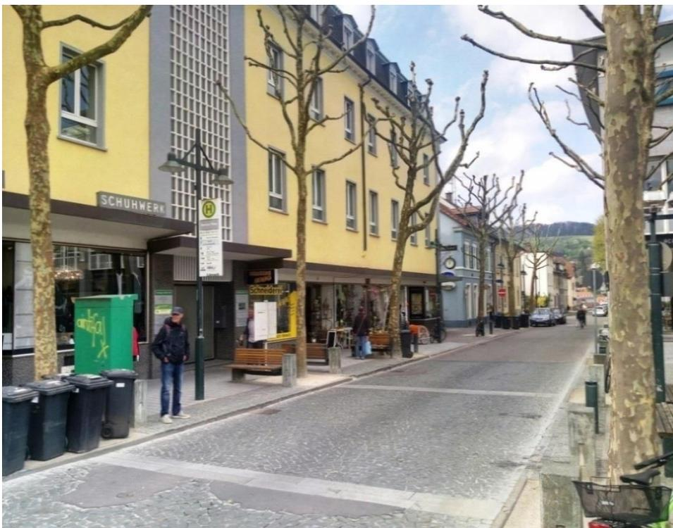
Haltestelle Senser Platz: Kein Fahrgastunterstand. In der Länge wäre eine Doppelhaltestelle möglich. Die Bordsteinhöhe ist zu gering, hier sollte ein Kassler Bord eingebaut werden. Die Aufstellfläche ist knapp bemessen. Die Fahrgasse könnte
