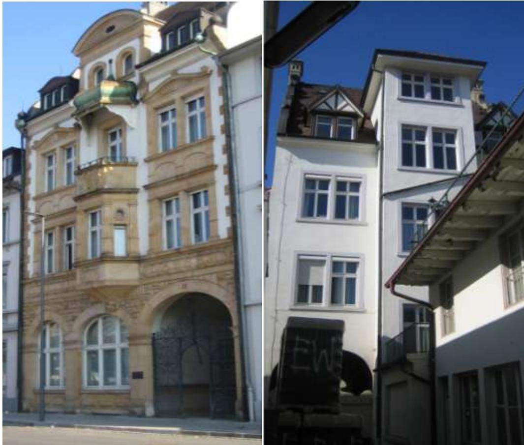
Abb. 13: Links eine noch typische Fassade in der Belchenstraße. Rechts die Gebäuderückseite, bei der lediglich noch die Fensterumfassung vorhanden ist. Hier könnte eine Dämmschicht von außen aufgebracht werden.
